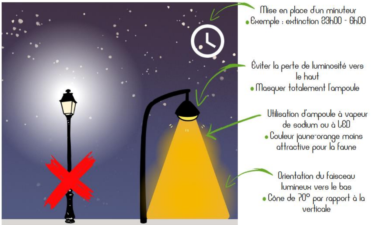
Figure 38 : Schéma d'un éclairage public adapté pour réduire son impact sur la pollution lumineuse (© ReNard)
